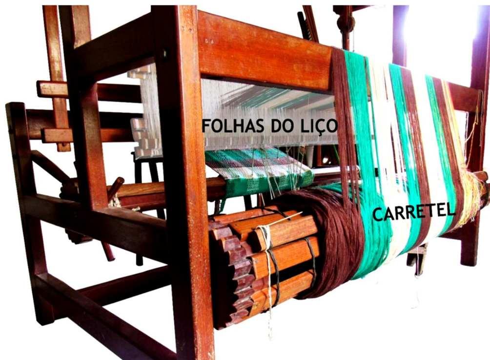
Figura 5 – Tear de D. Anésia com destaque para o carretel e as folhas do liço
